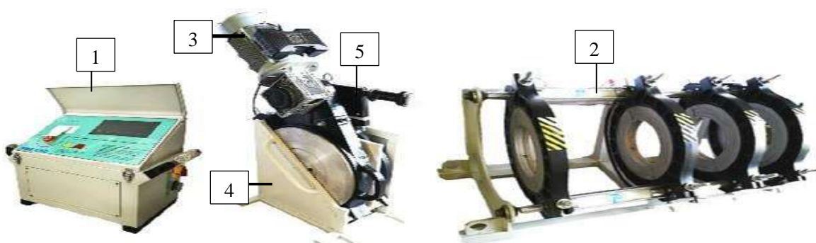
1. ЧПУ 2. Центратор 3. Торцеватель 4. Держатель 5. Нагревательный элемент
